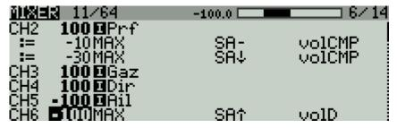
La profondeur doit se baisser à l'activation des volets, et il faut jouer sur les valeurs ratios (-10 et -30) pour régler la bonne compensation, donc à tester en vol!
