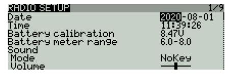
Calibration batterie Permet de corriger les erreurs d'affichage de la tension de la
