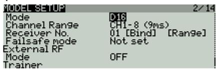
Attribuer un numéro au récepteur, c'est ce qui permet d'être sur que ce modèle ne démarrera qu'avec ce numéro de récepteur.
