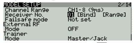
Activer le mode BIND : se mettre sur BIND et appuyer sur ENT
