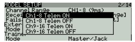
Normalement et sauf installation en « double réception », **on est en « Ch1-8 Telem ON »** Valider par **ENT**
