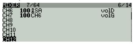
Si on veut adapter la position « moyennement baissé » du volet, inter SA en position centrale, on rajoute une ligne de mixage sur la voie CH6 qui s'active quand l'inter SA est en position centrale :
