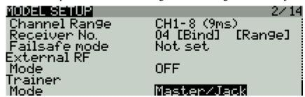
« Maitre / jack », c'est si on relie les 2 radios entre elles par un cable, sinon, il y a d'autres options pour faire le lien via un récepteur SBUS ou CPPM que l'on doit brancher dans la trappe de la radio.
